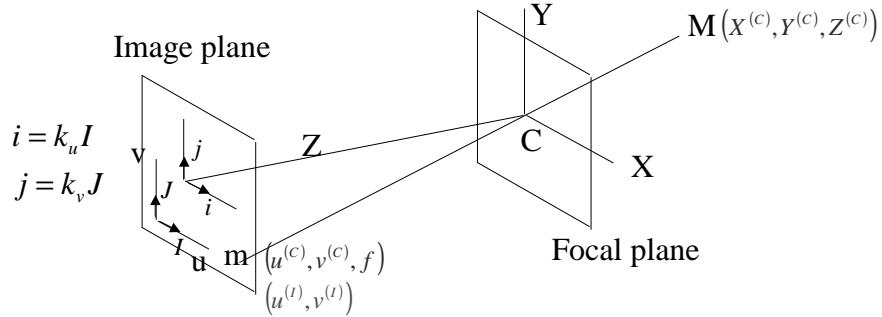
$$\begin{bmatrix} u^{(I)} \\ v^{(I)} \\ 1 \end{bmatrix} = \begin{bmatrix} k_u & 0 & 0 \\ 0 & k_v & 0 \\ 0 & 0 & 1 \end{bmatrix} \begin{bmatrix} u^{(c)} \\ v^{(c)} \\ 1 \end{bmatrix} + \begin{bmatrix} u_0 \\ v_0 \\ 0 \end{bmatrix} = \begin{bmatrix} k_u & 0 & u_0 \\ 0 & k_v & v_0 \\ 0 & 0 & 1 \end{bmatrix} \begin{bmatrix} u^{(c)} \\ v^{(c)} \\ 1 \end{bmatrix}$$
