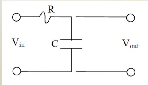
Fig. 1. The RC Circuit.
